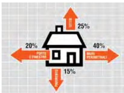
La maggior parte di tale energia viene tuttavia dispersa nell'ambiente (senza contribuire in alcun modo al comfort interno) sotto forma di perdite di calore, che in un edificio tipo avvengono principalmente in corrispondenza delle seguenti zone illustrate qui sopra:
