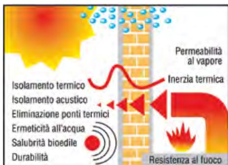
**SANAWARME** è uno speciale intonaco appositamente studiato per creare un involucro in grado di avvolgere in modo continuo ed omogeneo la superficie muraria apportandovi importanti vantaggi in termini di:
